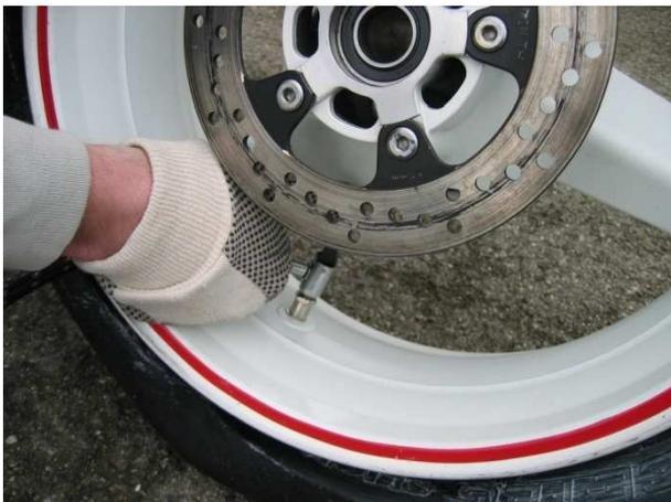
**Der Reifen wird nun mit ca. 3-4 bar aufgepumpt (ohne Ventileinsatz), damit der Reifen vollständig auf das Felgenbett rutscht. Das wird akustisch mit zwei lauten « Peng » Geräuschen angezeigt.**
