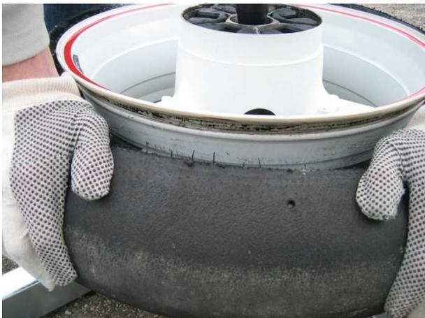
Der Reifen wird etwas gedreht und man wiederholt den Vorgang solange, bis sich der Reifen von der Felge vollständig gelöst hat (Natürlich auf beiden Seiten).
